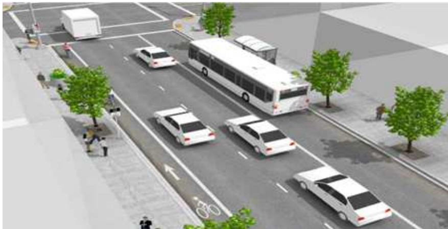
Ejemplo señalización carril bicicleta ubicado al lado izquierdo del carril para vehículos motorizados Fuente: NACTO
