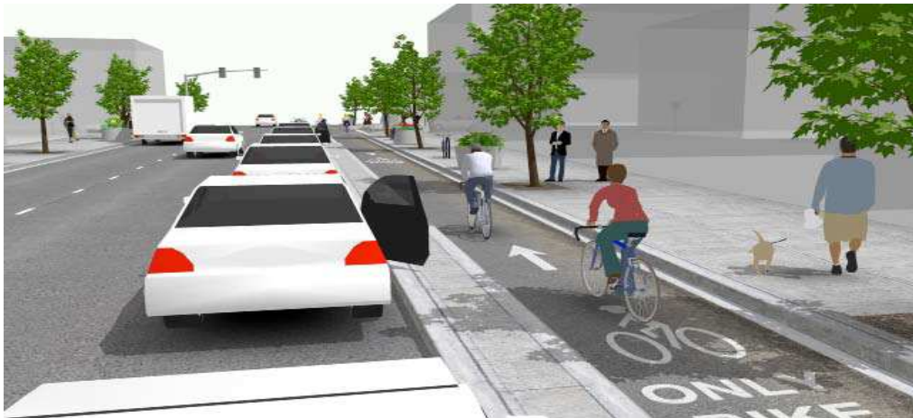
Ejemplo de señalización para carril bicicleta con espacio de seguridad para apertura de puertas con bordillo Fuente: NACTO
