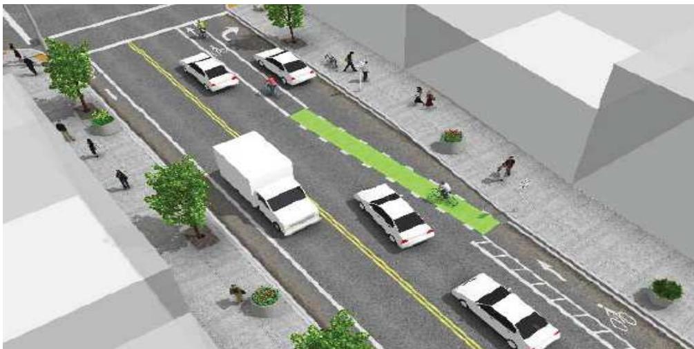
Ejemplo señalización de carril bicicleta con fondo verde, en intersección con giro derecha para vehículos motorizados, caso c) Fuente: NACTO
